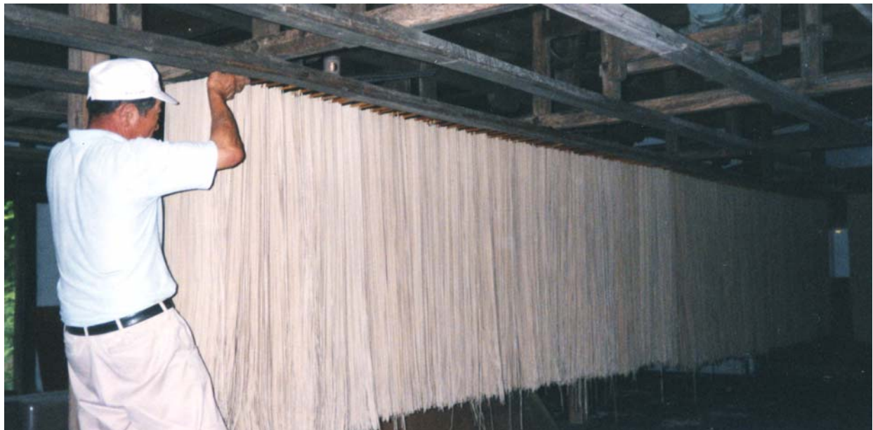
大谷製麺工場。竹の棒に二つ折りにぶらさげた生そばを等間隔に並べて乾す。天井には大型の扇風機。乾燥後は再び同様の姿勢で外し、裁断、袋詰め作業へと進む。大半が肉体労働。
